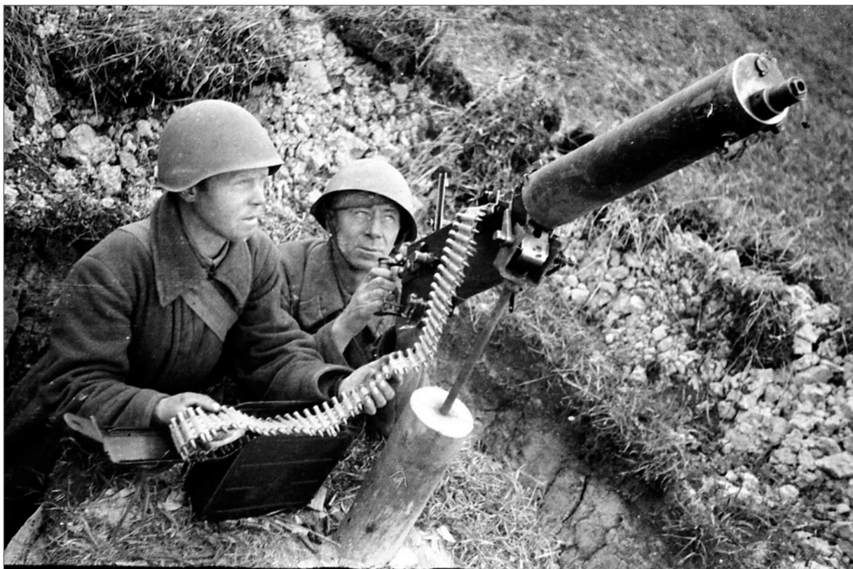
Кустарное зенитное приспособление для стрельбы из пулемета «Максим»
