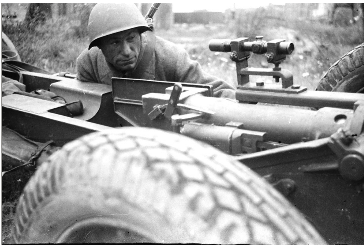
На орудие установлен прицел от снайперской винтовки
